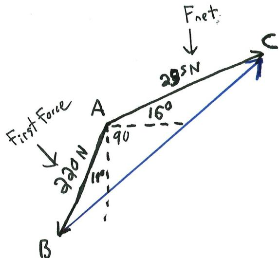
$$\angle A = 18^\circ + 90^\circ + 16^\circ = 124^\circ$$
